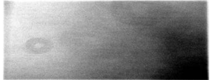
FIGURA 4 . IMAGEN DE FLAT OBTENIDO EN EL OBSERVATORIO ASTRONÓMICO DE SABADELL. LA IMAGEN DE FLAT, PERMITE CORREGIR LAS DIFERENCIAS DE SENSIBILIDAD EN CADA PÍXEL DE LA CCD Y CORREGIR PARCIALMENTE DEFECTOS ÓPTICOS EN LA CÁMARA O LAS LENTES DEL INSTRUMENTO UTILIZADO.
