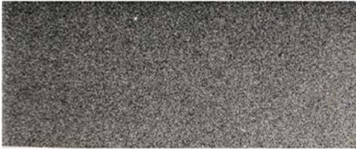
FIGURA 3. IMAGEN DE DARK OBTENIDO EN EL OBSERVATORIO ASTRONÓMICO DE SABADELL. IMAGEN OBTENIDA A LA MISMA TEMPERATURA Y MISMO TIEMPO DE EXPOSICIÓN QUE NUESTRAS IMÁGENES DE CAMPO CON LA FUENTE DE LUZ BLOQUEADA A LA CCD (OBTURADOR CERRADO), DE MODO QUE SE CAPTA SÓLO OSCURIDAD. SE OBTIENE ASÍ UNA IMAGEN DEL RUIDO CAUSADO POR EL RUIDO TÉRMICO Y OTROS PARÁMETROS DE RUIDO CONSTANTES. SUSTRAYENDO LOS DARK DE LAS IMÁGENES DE CAMPO SE ELIMINAN DICHS RUIDOS
