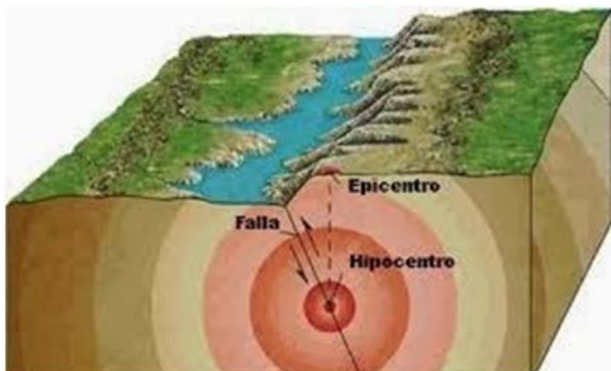
FIGURA 2. CUANDO SE REGISTRA UN TERREMOTO, LAS ONDAS SÍSMICAS SE PROPAGAN EN TODAS LAS DIRECCIONES DESDE EL HIPOCENTRO. EL ESTUDIO DE LAS ONDAS REGISTRADAS PERMITE LOCALIZAR EL EPICENTRO Y LA PROFUNDIDAD A LA QUE SE HA ORIGINADO EL TERREMOTO (IMAGEN DE HTTP://WWW.OBSEBRE.ES/CA/SISMICA-INSTRUMENTS-I-METODOLOGIA ).
