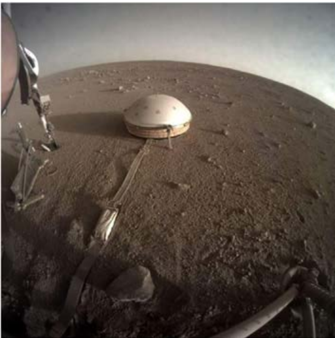
FIGURA 9. SISMÓGRAFO DEL MÓDULO DE ATERRIZAJE InSight EN MARTE. IMAGEN DE LA NASA.
