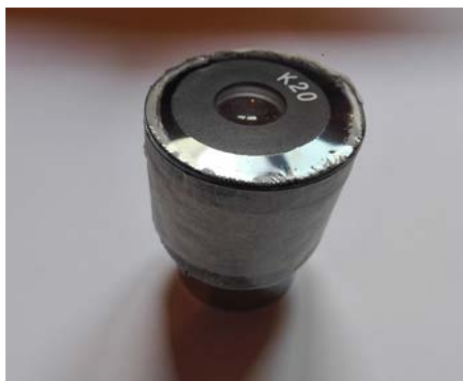
IMAGEN 2.- Ocular con protección a base de acetato transparente de cocina
