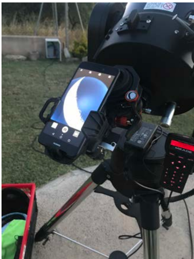
IMAGEN 6.- DETALLE DEL MOVIL ADAPTADO AL OCULAR hoja solo por los extremos, para mantener limpia
