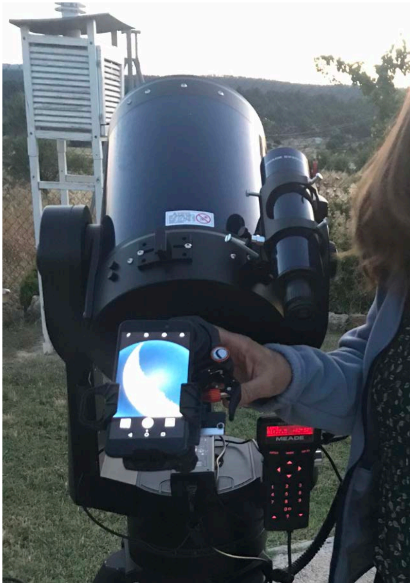
IMAGEN 5.- OBSERVACIÓN MEDIANTE EL ADAPTADOR DEL MÓVIL AL OCULAR de 40 o 50 cm. del ocular y observan a través de la pantallita. Estos adaptadores, sirven para cualquier tipo de móvil, sólo hay que abrir la función de la cámara y ajustar la imagen.
