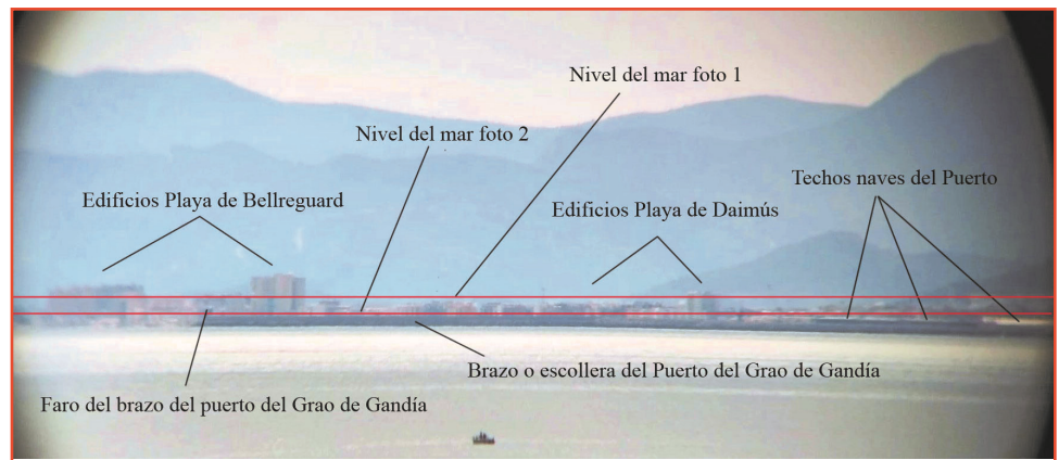
Figura 6 (arriba): Fotografía desde el punto "A" (0,50 m sobre el nivel del mar) en la playa de Cullera. Se aprecian las partes superiores de edificios en las playas de Daimús y Bellreguard. Las partes inferiores quedan ocultas por la curvatura terrestre; Figura 7 (centro): Misma escena desde el punto "B" (7,50 m sobre el nivel del mar). Se observan más zonas inferiores de los edificios que en la Fig. 6, debido a la mayor elevación; Figura 8 (abajo): Vista desde el punto "C" (25 m sobre el nivel del mar). Se observan casi completamente las partes inferiores de las estructuras, evidenciando el efecto de la curvatura terrestre.
